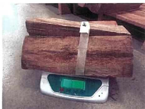
Rys. 4.3. Ważenie porcji drewna przygotowanej do testu spalania.
